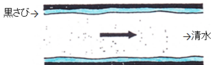
図-4 不動態皮膜の形成状況
