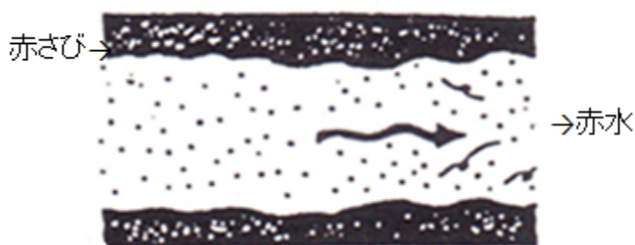
図-2 赤さびの発生状況
